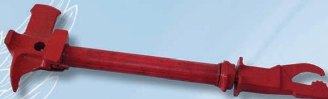
Инструмент ручной аварийно-спасательный предназначен для выполнения операций, связанных с деформацией и разрушением элементов конструкций, с целью расширения доступа к пострадавшим.
